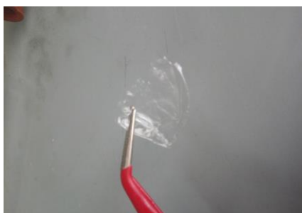
Εικόνα 1: Μembrάνη με ενσωματωμένα βιοστατικά είδη, προερχόμενη από υδατοδιαλυτά πολυμερή.
