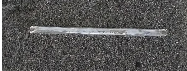
Εικόνα 1 Μικροβιοαντιδραστήρας: Τριχοειδής σωλήνας μήκους 3cm και εσωτερικής διαμέτρου ~1mm στα εσωτερικά τοιχώματα του οποίου έχει πραγματοποιηθεί ανάπτυξη νανοράβδων ZnO και ομοιοπολική ακινητοποίηση ενζύμου β-γλυκοσιδάσης
