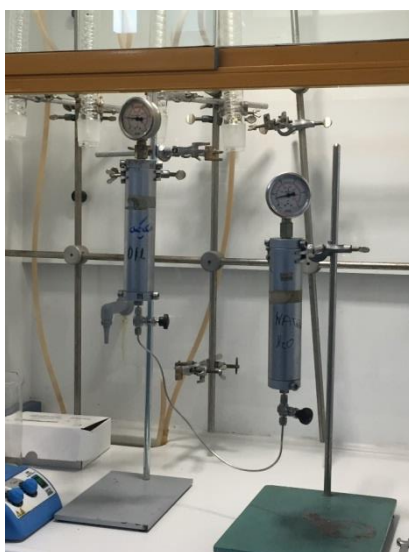
Σχήμα 3. Συνδεσμολογία δοχείων υψηλής πίεσης σε σειρά.
