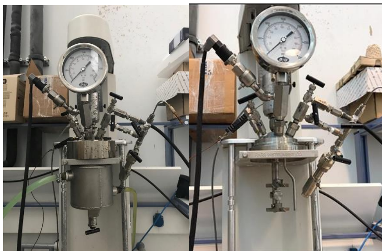
Σχήμα 1. Αντιδραστήρας υψηλής πίεσης της Parr Instruments.
