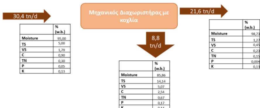
Σχήμα 3. Μηχανικός διαχωρισμός σταθεροποιημένης λάσπης με κοχλία
