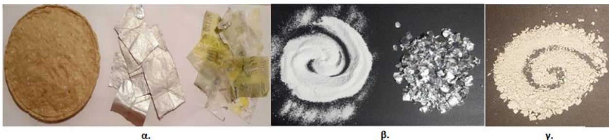
Σχήμα 4. Τα προϊόντα α. της υδροπολτοποίησης (Χαρτί, Al-PE laminate και Outer Layer PE) και της ΕΔΑ από β. τα Al-PE laminates(LDPE και Al) και γ. την Outer layer PE.
