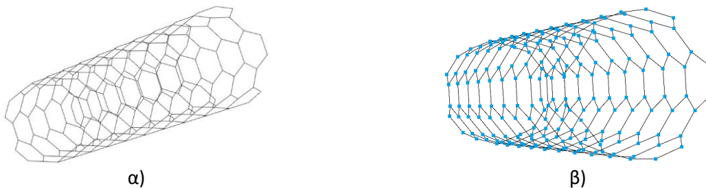
Σχήμα 2. α) Γεωμετρία του νανοσωλήνων άνθρακα (5,5), β) Πλέγμα πεπερασμένων στοιχείων. Τα τετράγωνα αναπαριστούν τους κόμβους του πλέγματος και οι γραμμές τις δοκούς.
