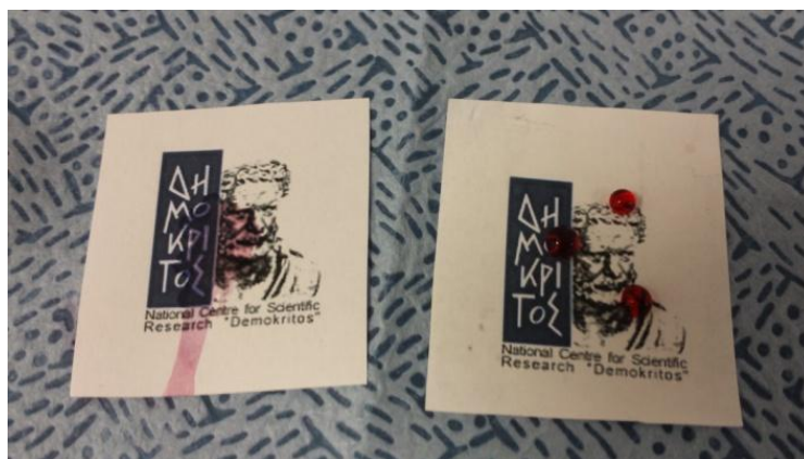
Σχήμα 3. Διαβροχή χαρτιού με έγχρωμη εκτύπωση πριν και μετά την κατεργασία με πλάσμα 2 σταδίων (εγχάραξη και ενπόθεση).
