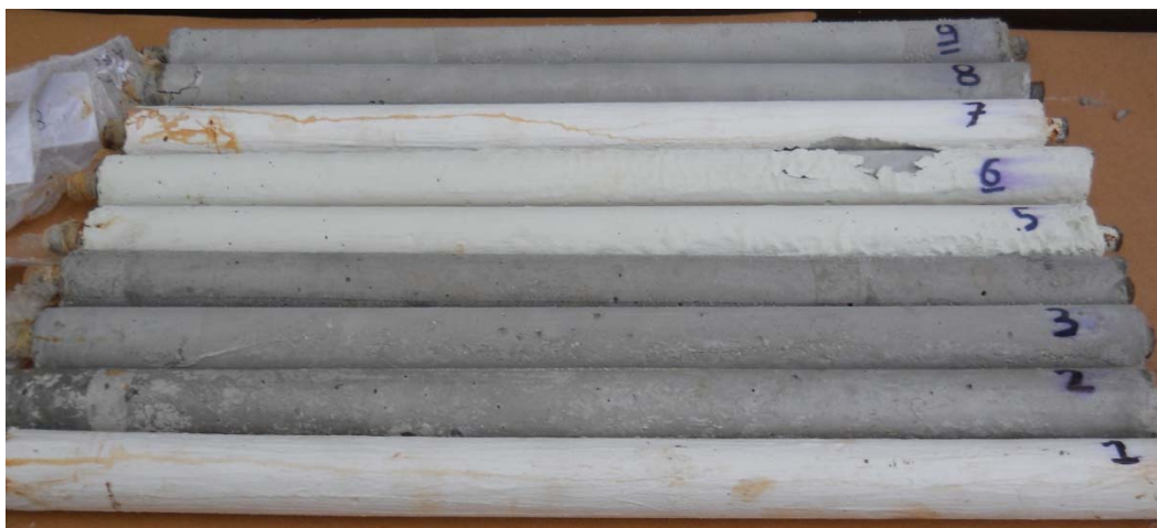
Εικόνα 2. Γενική άποψη των δοκιμίων μετά από έκθεση σε διαβρωτικό περιβάλλον.
