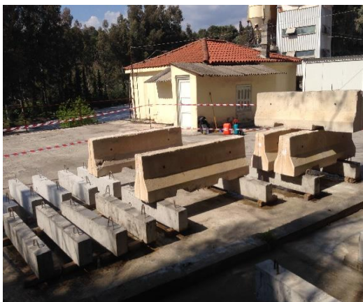
Σχήματα 1,2. Πειραματική διάταξη δοκών οπλισμένου σκυροδέματος, μπλοκ φόρτισης
