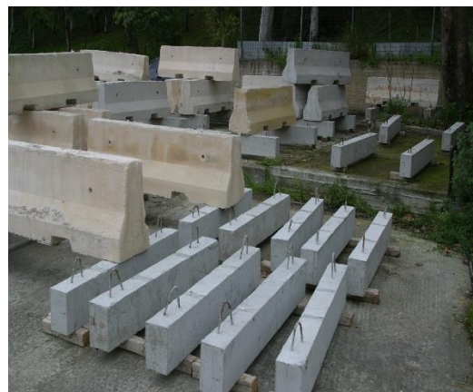
Σχήματα 1,2. Πειραματική διάταξη δοκών οπλισμένου σκυροδέματος, μπλοκ φόρτισης
