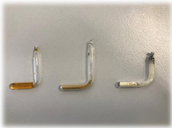
Σχήμα 2. Δείγματα που παρασκευάστηκαν για μετρήσεις Πυρηνικού Μαγνητικού συντονισμού στον μαγνήτη 4.7T. (α) BMIM TCM (β) MCM-41 + BMIM TCM (γ) SBA-15 +BMIM TCM
