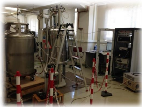
Σχήμα 3. Πειραματική διάταξη θερμοκρασιακών μετρήσεων με χρήση υγρού Ηλίου στον μαγνήτη 4.7T.
