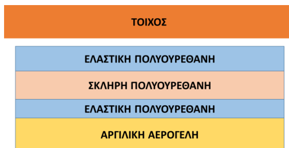
Σχήμα 2. Απεικόνιση του συνδυασμού των μονωτικών στρωμάτων
