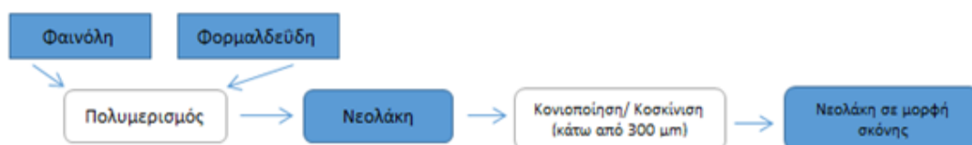
Σχήμα 1. Διαδικασία εργαστηριακής παραγωγής ρητίνης νεολάκης.
