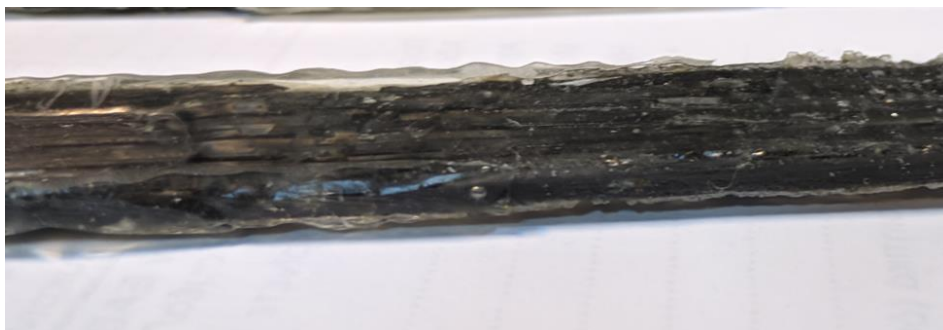
Σχήμα 5. Το ίδιο ακριβώς σημείο του σύνθετου υλικού εποξειδικής ρητίνης μετά την επισκευή
