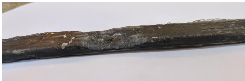
Σχήμα 4. Σημείο σε δοκίμιο σύνθετου υλικού εποξειδικής ρητίνης πριν την επισκευή
