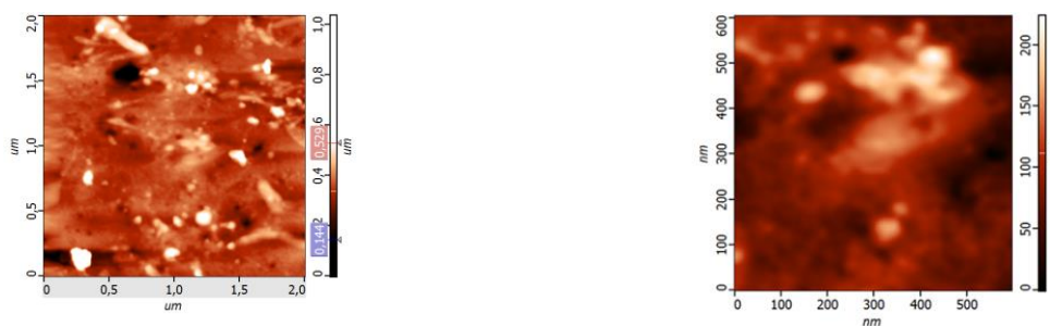
Σχήμα 1. Τοπογραφική απεικόνιση AFM της ανιονικής PCA μεγάλης περιοχής σάρωσης (αριστερά) και μικρής περιοχής (δεξιά).
