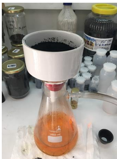
Εικόνα 1. α. Ανάμιξη στερεών και υγρών προϊόντων με διαλύτη, β. Διήθηση, γ. Βιοέλαιο
