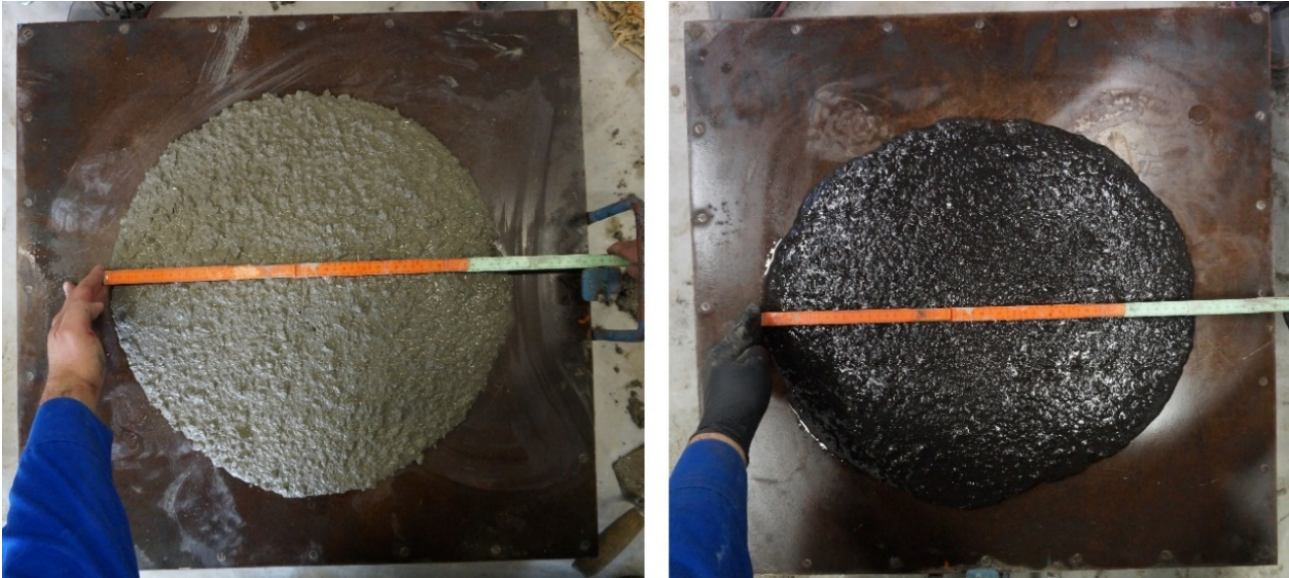
Σχήμα 1. Δοκιμή εξάπλωσης στο κλασικό σκυρόδεμα CC (αριστερά) και στο γεωπολυμερικό σκυρόδεμα GC (δεξιά).
